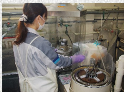
小型精密Lap機での 研磨条件の研究
